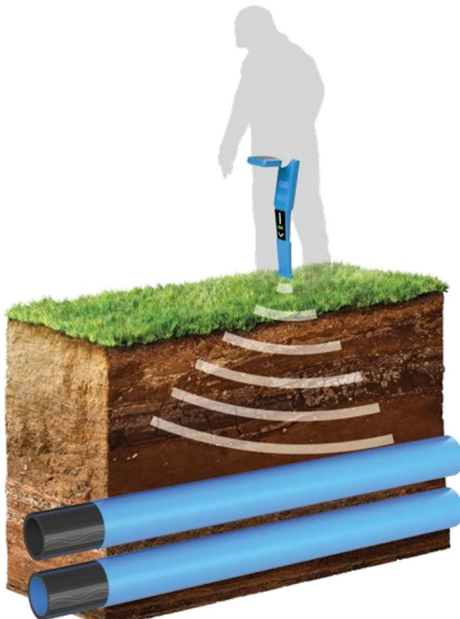
\* Для определения местоположения сетей используется траскоискатель.
