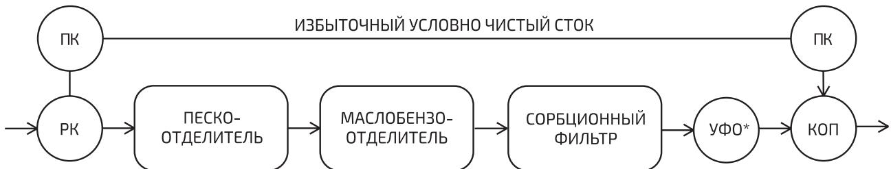
Однолинейная проточная схема очистного сооружения ПОЛИПЛАСТИК.
