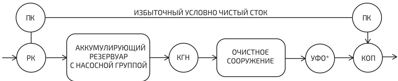
Однолинейная схема очистного сооружения ПОЛИПЛАСТИК. Производительность: от 3 до 130 л/с.
