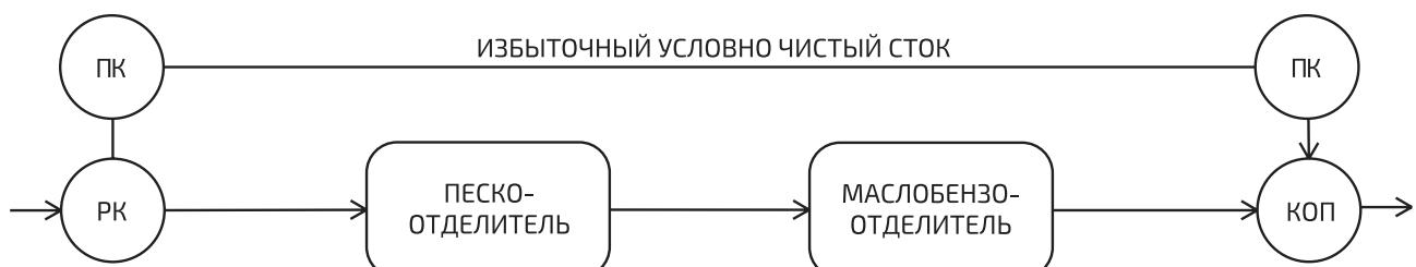
Однолинейная проточная схема очистного сооружения ПОЛИПЛАСТИК.
