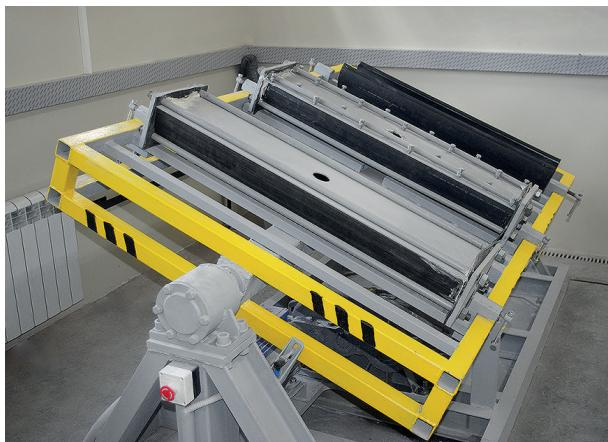
Суть метода состоит в измерении величины износа отрезка полимерной трубы смесью воды и крупных абразивных частиц (средний размер 6 мм). Движение смеси обеспечивается изменением наклона образца на  $\pm 22,5^\circ$  с частотой 20 циклов в минуту.
