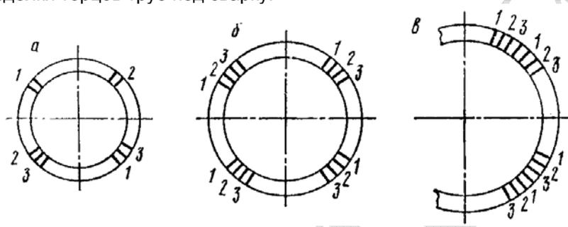
Рис. 3. Схема вырезки образцов для механических испытаний
