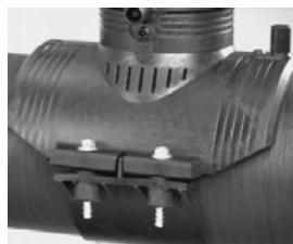
1. Крепеж седелок диаметром 63-160 мм осуществляется при помощи двух винтов. Чтобы зафиксировать седелку относительно трубы, необходимо попеременно затянуть эти винты до упора.
