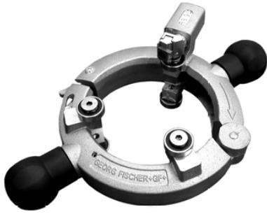
1. Протереть трубу в месте сварки. При помощи поворотного зачистного инструмента снять оксидный слой полиэтилена, соблюдая требования к минимально допустимой толщине стенки трубы.
