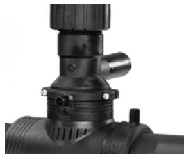
3. Убедиться, что врезной отвод полностью вставлен в седелку. Сориентировать поворотный отвод и попеременно затягивать прижимные винты седелки до его полной фиксации.
