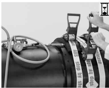
13. Для сварки второй стороны муфты, устанавливать и выравнивать подушки по второму вырезу фитинга допускается не ранее чем через 20 минут после начала периода охлаждения. Снова выполнить центровку фиксирующих ремней вокруг обжимных подушек и произвести аналогичное нагнетание давления (вся операция должна занять не более двух минут). Подключить сварочные кабели к разъемам на второй стороне муфты и выполнить сварку.
