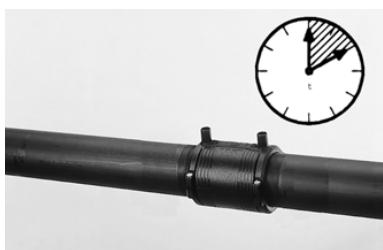
13. По завершении сварки проверить состояние индикаторов на фитинге и показания на дисплее сварочного аппарата, затем отключить кабели.
