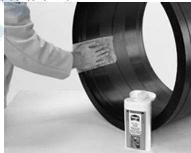
8. Не прикасаясь к свариваемым поверхностям, извлечь фитинг из упаковки и осмотреть его на предмет явных повреждений. Убедившись в их отсутствии, обезжирить обе свариваемые поверхности муфты с помощью чистой тканевой салфетки, пропитанной растворителем Tangit PE.
