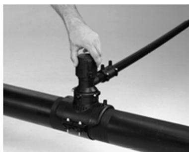
13. Затянуть винтовой или сварочный колпачок вручную (без паст и смазок).
