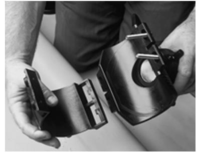
3. Не прикасаясь к свариваемым поверхностям, извлечь седелку из упаковки. Собрать шарнирное соединение, убедиться в том, что выступы нижней части правильно входят в проушины верхней части. Чтобы облегчить процесс установки винтов и упростить процесс монтажа, рекомендуется ввернуть стяжные винты до установки седелки на трубу.
