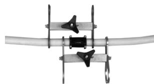
Пара наложенных со смещением относительно соединения трубных зажимов образует счетверенный зажим, позволяющий свести механическое напряжение на стыке практически к нулю.
