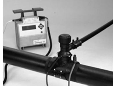
9. По завершении сварки проверить состояние индикаторов на фитинге и показания на дисплее сварочного аппарата, после чего отключить кабели.
