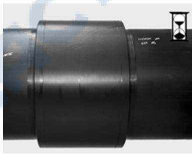
15. Проверить состояние обоих сварочных индикаторов, а по завершении минимального периода охлаждения произвести опрессовку.
