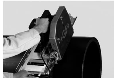
2. Протереть трубу чистой, сухой тканью, обрезать край под прямым углом и удалить образовавшиеся заусенцы. Поскольку иногда при изготовлении происходит склонение труб на торцах, рекомендуется сначала отрезать трубу до требуемой длины (например, с помощью трубореза KS 1600), и только потом производить монтаж. Оба среза трубы необходимо очистить от заусенцев.
