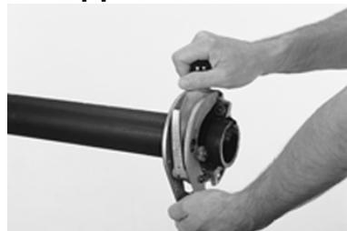
2. При помощи поворотного зачистного инструмента равномерно снять оксидный слой, соблюдая требования к минимально допустимой толщине стенки трубы.
