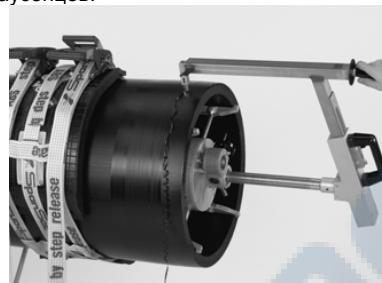
5. Удалить оксидный слой полиэтилена при помощи подходящего зачистного инструмента (с учетом требований к минимально допустимой толщине стенки трубы). Трубы после скругления подвергают непрерывной зачистке до тех пор, пока муфта не наденется на трубу без затруднений. Нарушение требований по наименьшему допустимому диаметру зачистки не допускается (см. п. 3)! Многократная зачистка с целью охвата всей поверхности склоненного края трубы не обязательна!
