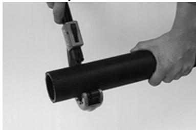
1. Протереть трубу(ы), отрезать под прямым углом и удалить заусенцы.
