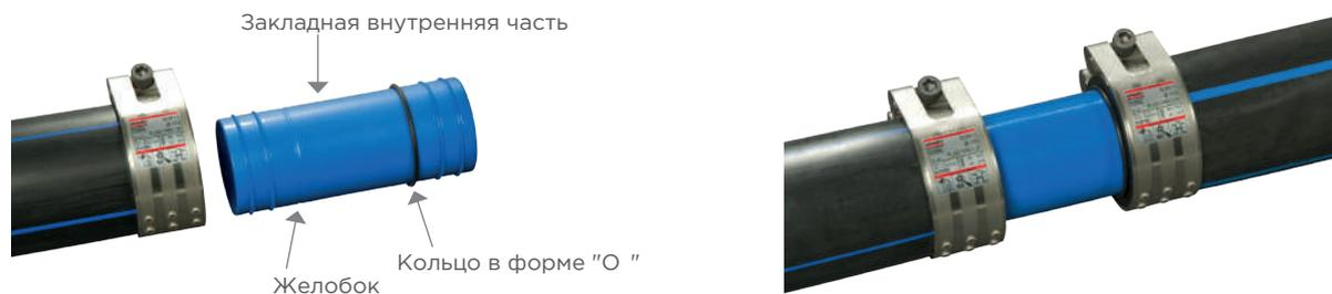
Выставьте 100 мм трубы. Слегка отогните концы трубы и вставьте ремонтную муфту с уплотнительным кольцом в один из концов трубы. Выровняйте хомуты по концам трубы.
