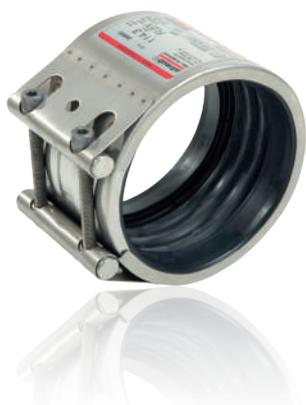
Разница в диаметрах соединяемых труб может составлять 10-30мм. При больших различиях в диаметрах между двумя частями муфты устанавливается редукционный переходник. Трубы с меньшей разницей диаметров (5-9 мм) могут быть соединены с помощью STRAUB-FLEX 2 / 3 в специальном исполнении (по запросу).
