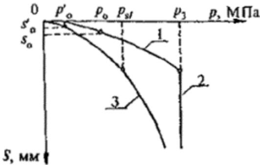
1 - осадка; 2 - просадка при заданном давлении; 3 - осадка после замачивания
