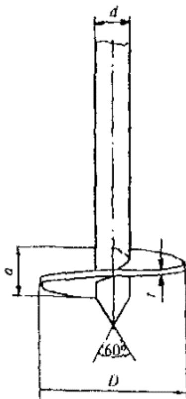
B.2 В конструкцию винтового штампа, предназначенного для испытания грунтов в массиве без бурения скважины, должно входить устройство, позволяющее при измерениях осевой нагрузки на штамп исключить влияние трения грунта по боковой поверхности ствола.
